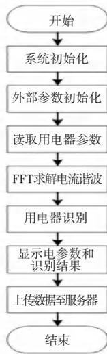
图 5 STM32 主程序流程图
