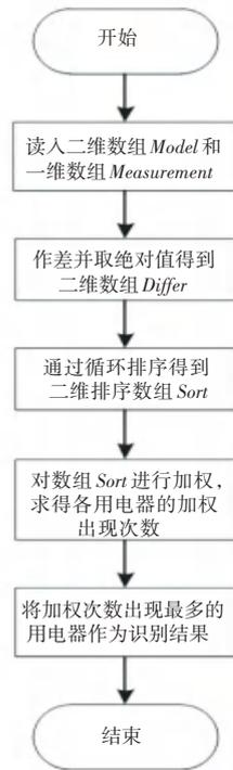
图 6 识别算法程序流程图
